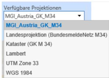
Wählen Sie die passende Projektion aus und klicken Sie auf „Definitionen Setzen“. Die Daten werden hochgeladen und wenn die Projektion korrekt ist, springt der Kartenausschnitt sofort auf den Abdeckungsbereich des Datensatzes.
